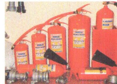
Заряженность порошковых огнетушителей закачного типа проверяется визуально по манометру в сроки определенные заводом-изготовителем, но не реже одного раза в год. Перезаряжаются через пять лет. Могут храниться в диапазоне температур от -40 гр.С до +50 гр.С.
